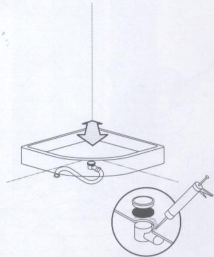
Τοποθετούμε στην ντουζιέρα τη βαλβίδα αποχέτευσης (χρησιμοποιούμε σιλικόνη για στεγανότητα) και τη συνδέουμε με το σιφώνι του δαπέδου, χρησιμοποιώντας εύκαμπτο οσιλίνα.
