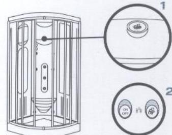
Οι καθαλατώσεις του λέβητα της ατμογεννήτριας πρέπει να αφαιρώνται μετά από 8-10 ώρες λειτουργίας του ατμόλουτρου. Η συντήρηση γίνεται σε καμπίνα εκτός λειτουργίας.
