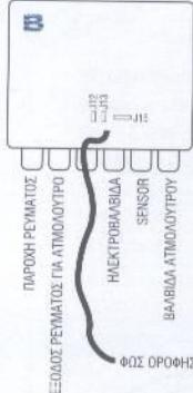
Ανοίξτε το κουτί Β και συνδέστε το καλώδιο φωτός της οροφής στις υποδοχές J12 & J13 (για λευκό φώς) ή στην υποδοχή J15 (για χρωματοθεραπεία).
